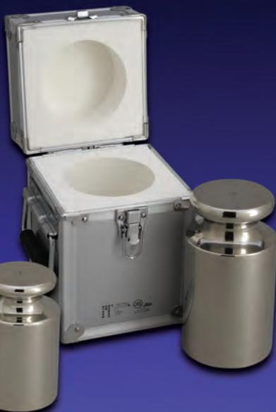
JIS規格への適合により、材質・磁性・表面粗さなど品質が保証されているだけでなく、国際法定計量機構(OIML)の勧告(R111)にも準拠しています。JCSS登録事業者の校正を受けることによって、JCSS標準分銅にできます。また、収納ケースも付属しており、リーズナブルな価格となっております。
